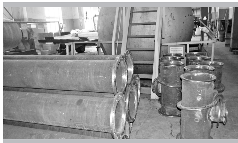
Детали хлоропровода: в очередь на гуммировку
